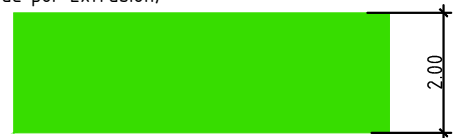
Faja de cruce y Bike Box de Ciclovía (Pintura Termoplástica verde por Extrusión)
